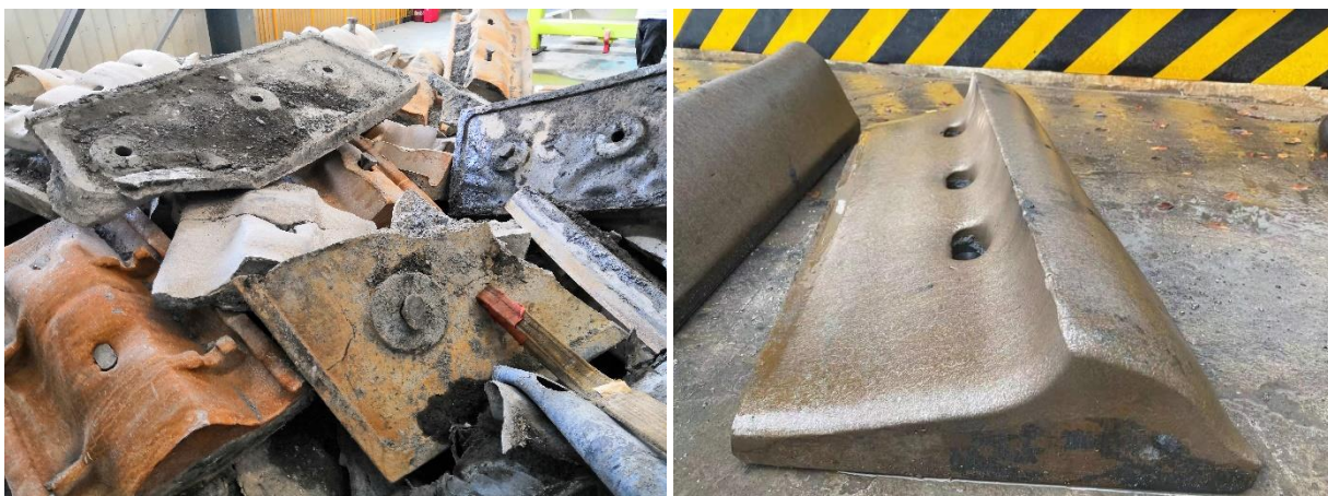
原铸造成型高锰钢衬板应用3个月和现用贝氏体锻造成型应用5个月过后,拆除下来的衬板对比
